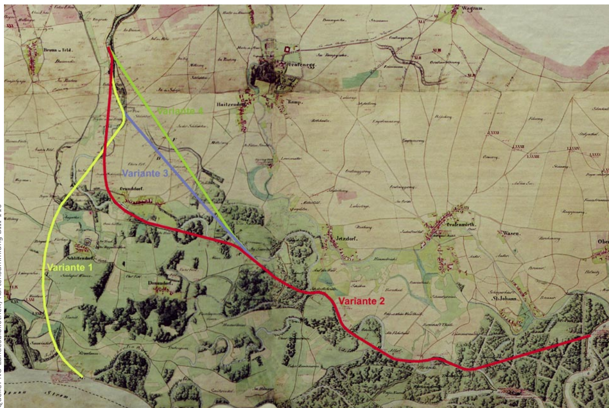
Ausschnitt aus der Flusskarte von Lilienbrunn um 1829 mit Hervorhebung der unterschiedlichen Durchstichvarianten
